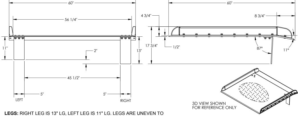
**LEGS:** RIGHT LEG IS 13" LG, LEFT LEG IS 11" LG. LEGS ARE UNEVEN TO CREATE A GAP SO DOCKBOARD CAN BE PICKED UP BY A FORK LIFT
