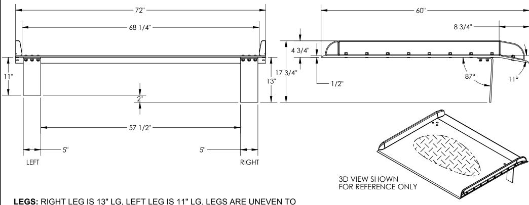
CREATE A GAP SO DOCKBOARD CAN BE PICKED UP BY A FORK LIFT
