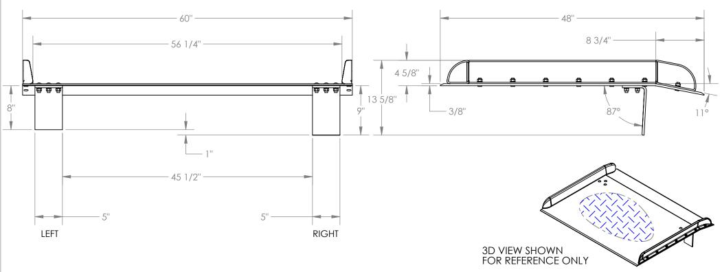
LEGS: RIGHT LEG IS 9" LG, LEFT LEG IS 8" LG. LEGS ARE UNEVEN TO CREATE A GAP SO DOCKBOARD CAN BE PICKED UP BY A FORK LIFT
